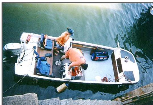
Blick auf das Motorrettungsboot „Adler Köln 2/43“, welches in Köln am Fühlinger See stationiert ist. Motorisiert ist das Boot mit einem 40 PS - Honda 4-Takt-Außenbordmotor. Die Besatzung besteht aus einem Bootsführer und zwei Bootsgasten (Rettungsschwimmer).
