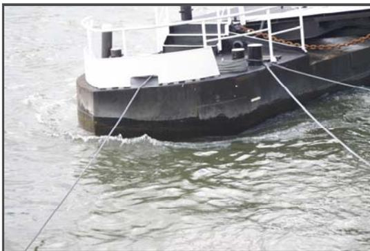
Strömungsverhältnisse am Schiffsanleger: Wasserstau stromaufwärts.
