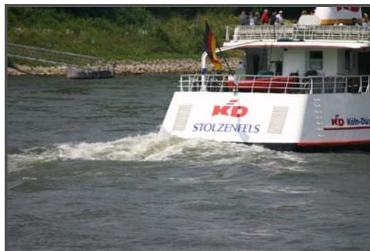
Blick auf den Heckbereich eines Personenschiffs. Insbesondere die großen Personenschiffe fahren sehr schnell und erzeugen hohe Wellen.
