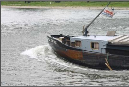
Ansicht eines Berufsschiffs mit spitzem Bug. Gut zu erkennen ist der Wasserstau.
