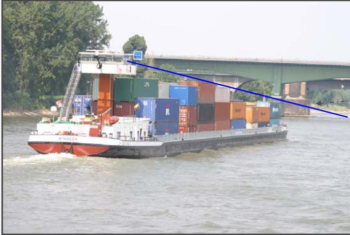
Sichtlinie des Schiffsführers. Der Bereich, der sich unterhalb dieser Linie befindet, ist vom Steuerstand aus nicht einzusehen.
