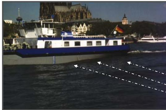
Heckansichten eines Berufsschiffs mit spitzem Bug. Zur erkennen sind das Schraubenwasser und der Bereich, wo der starke Sog auftritt.
